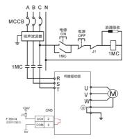
MCCB: 空气开关 1MC: 交流接触器
