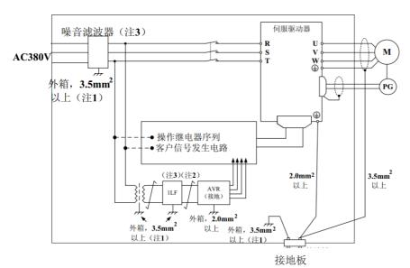
注 1: 用于接地的外箱连接电线请尽可能使用 3.5mm²以上的粗线 (编织铜线比较合适)。
