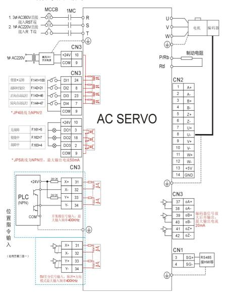
MCCB: 空气开关 1MC: 交流接触器
